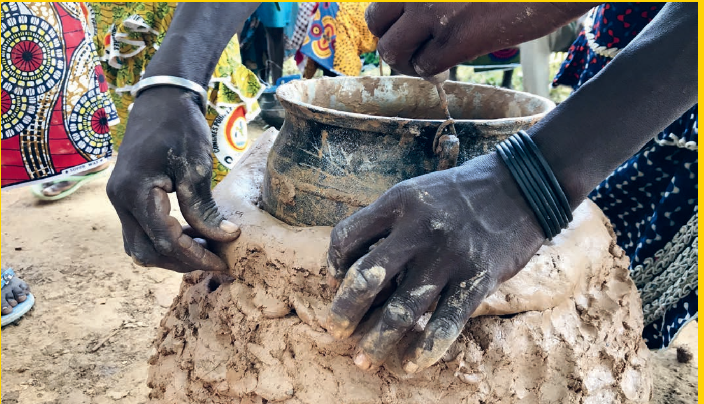
Mit eigenen Händen bauen Frauen energieeffiziente Kochstellen aus Lehm, Stroh, Dung und Wasser
